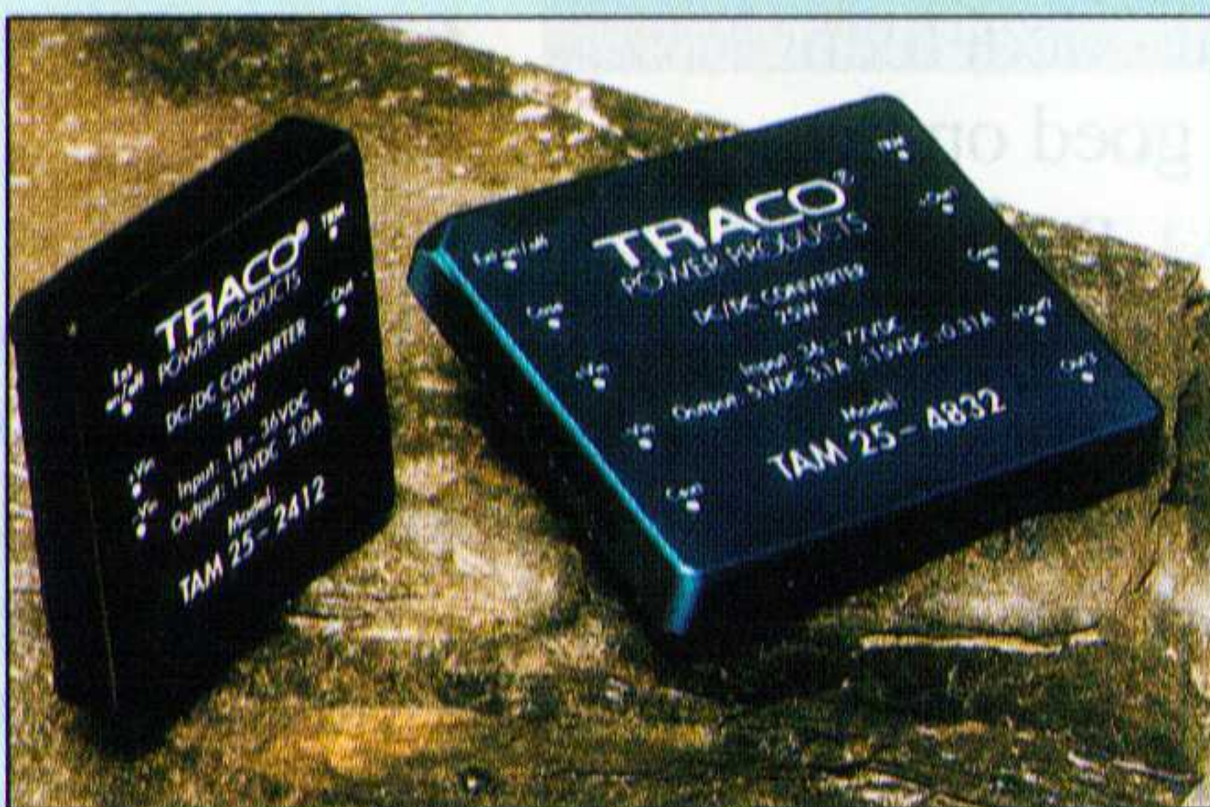
Fig. 3 De converters maken gebruik van de SMD-hybride techniek op een keramisch substraat, waardoor een goede warmte-overdracht is verkregen.
